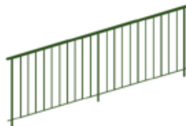
Remplissage barres verticales.
