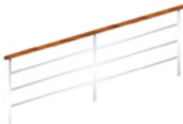
Main courante en bois, barres en inox.
